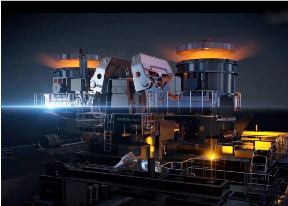
Die Gießbühne der neuen Brammenstranggießanlage bei Nucor in Brandenburg, Kentucky, USA .
